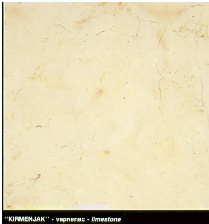
Slika 2.23. - Gusti vapnenac Kirmenjak (Pietrara d'Istria, Orsera, Avorio) otporan na agresiju kompleksnih agenasa iz mora, što je posebice došlo do izražaja u Veneciji, gdje su višestoljetne građevine od Kirmenjaka odolile zubu vremena.
