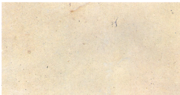
Slika 2.39. - Kamen vinicit, pretežito žućkaste boje, fino-zrnate pjeskovite strukture, porozan je i ima malu volumsku masu
