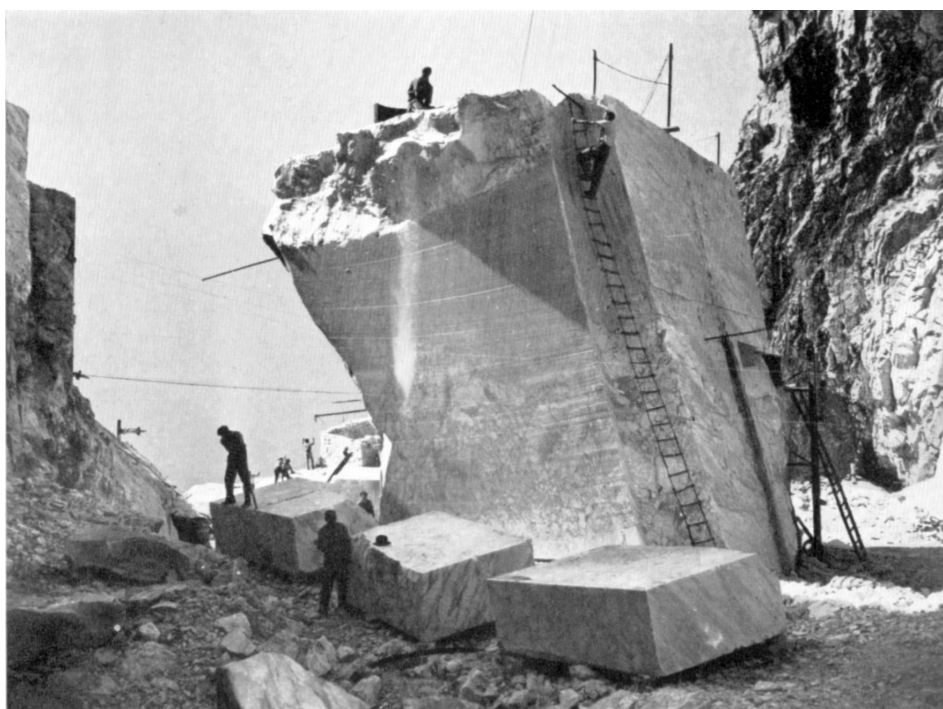
Slika 7.30. - Vađenje komercijalnih blokova iz velikog primarnog bloka arabescato na M. Altissimo (Italija)
