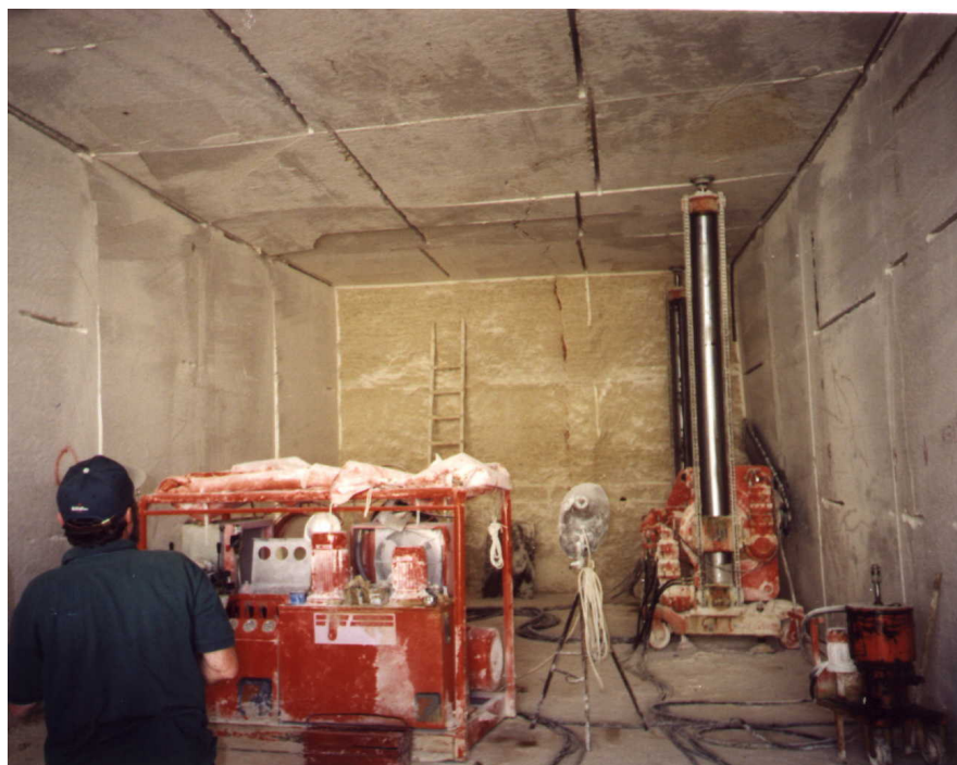
Slika 7.26. - Lančana sjekačica Fantini u podzemnom kopu Kanfanar
