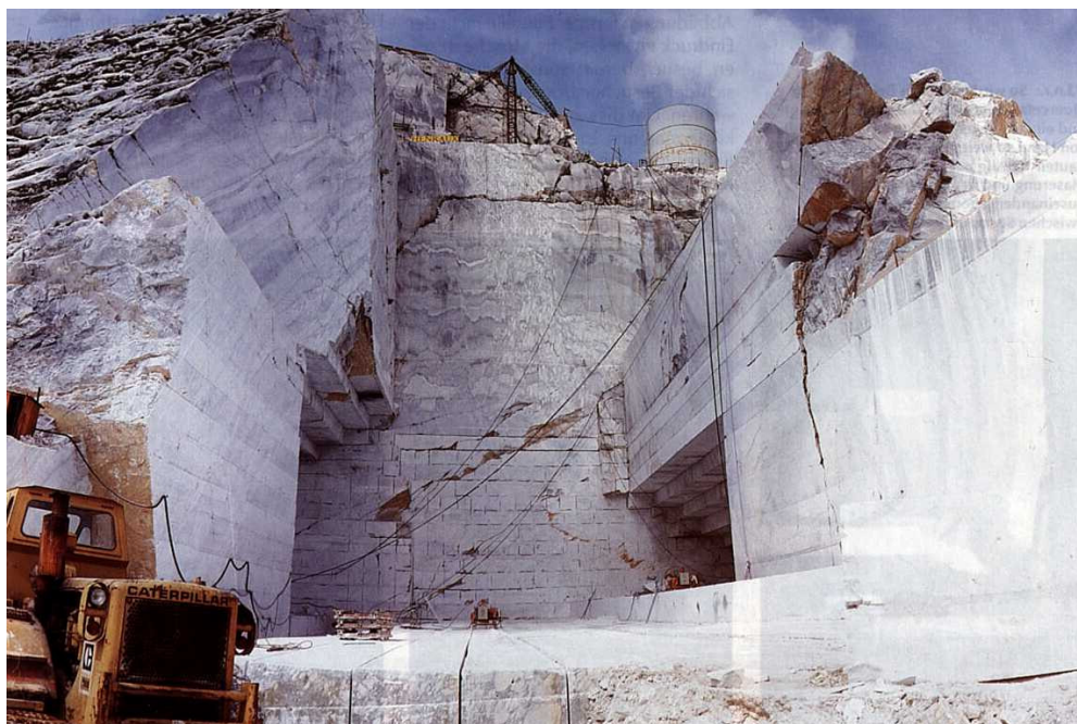
Slika 7.4. - Prijelaz iz površinske u podzemnu eksploataciju u ležištu Arabescato Cervaiola
