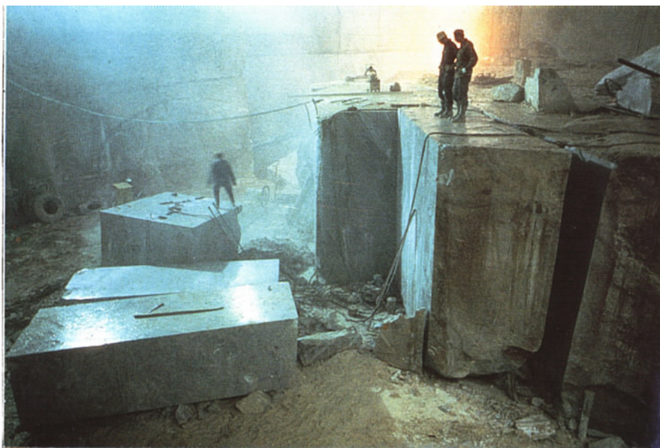
Slika 7.20. - Podzemno otkopavanje u višeetažno razvijenom kamenolomu
