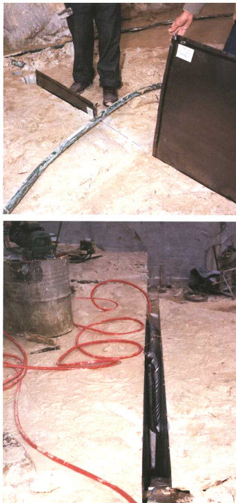
Slika 12.13. - Potiskivanje bloka vodenim jastucima - garnitura Hydrobag
