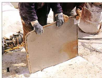
Slika 12.13. - Potiskivanje bloka vodenim jastucima - garnitura Hydrobag
