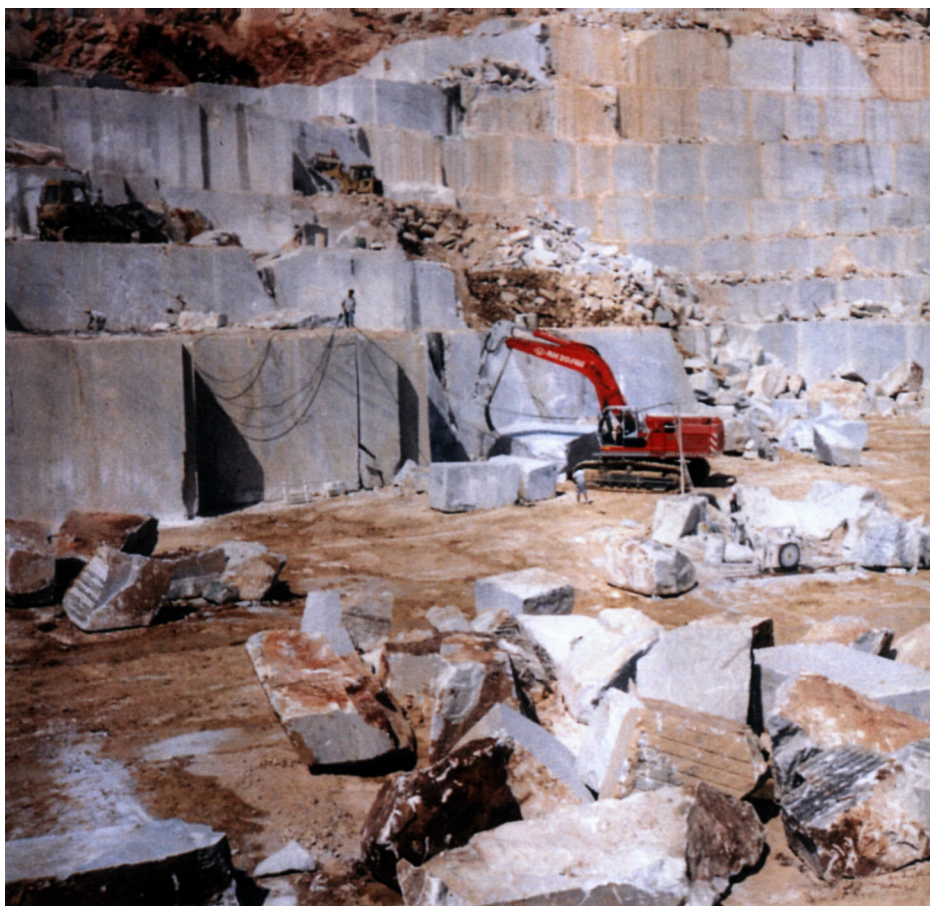
Slika 12.19. - Rad na obaranju i premještanju blokova hidrauličnim bagerom s obrnutom lopatom (O&K RH 20) u ležištu mramora Marmara Kavala (Grčka)
