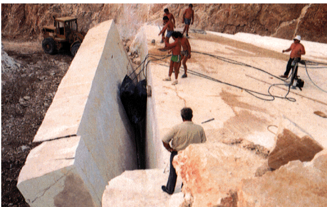
Slika 12.12. - Obaranje primarnog bloka pomoću zračnih jastuka u kamenolomu Kanfanar
