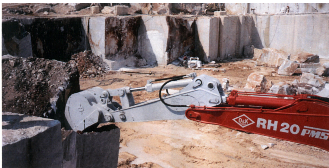
Slika 12.18. - Obaranje bloka mase 20 t hidrauličnim bagerom s dubinskom lopatom O&K RH 20 zahvaćanjem bloka s donje etaže
