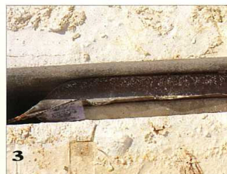
Slika 12.13. - Potiskivanje bloka vodenim jastucima - garnitura Hydrobag
