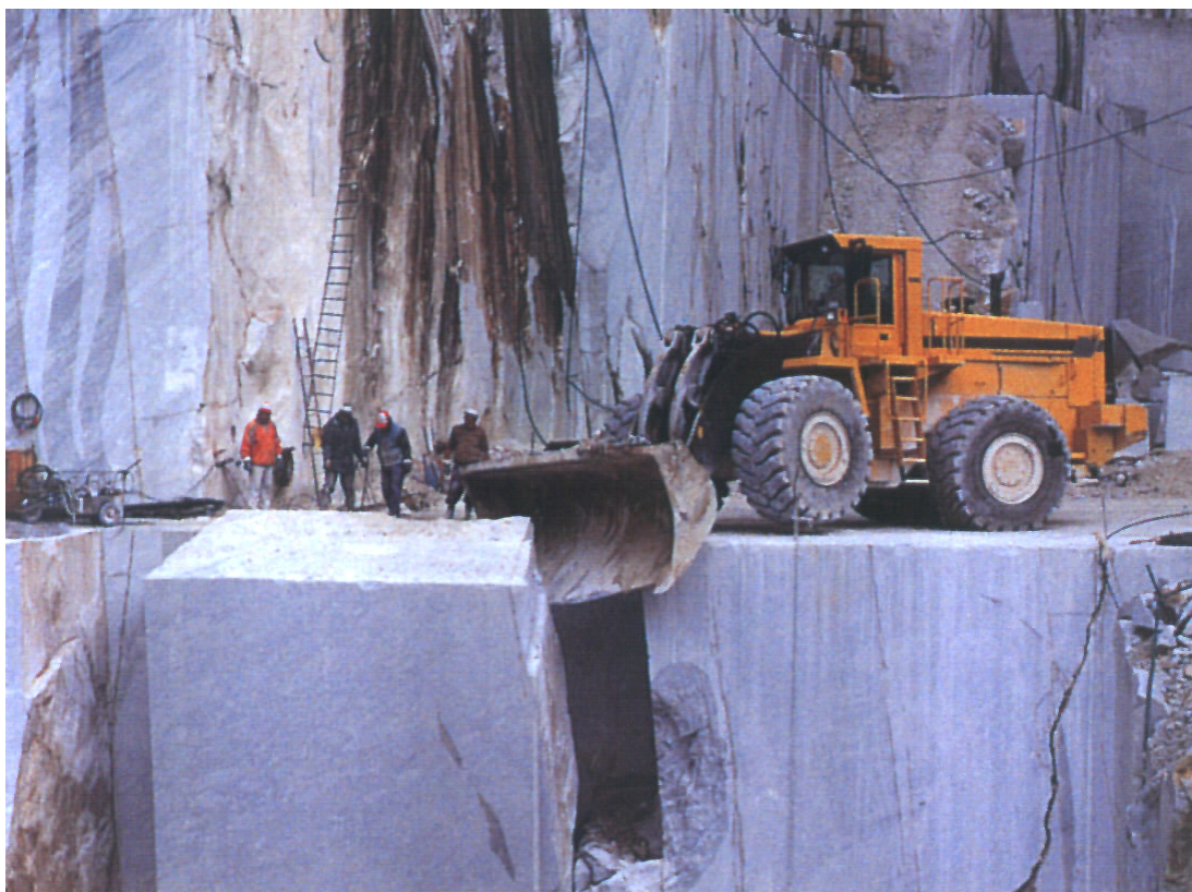
Slika 12.17. - Poguravanje primarnog bloka utovaračem
