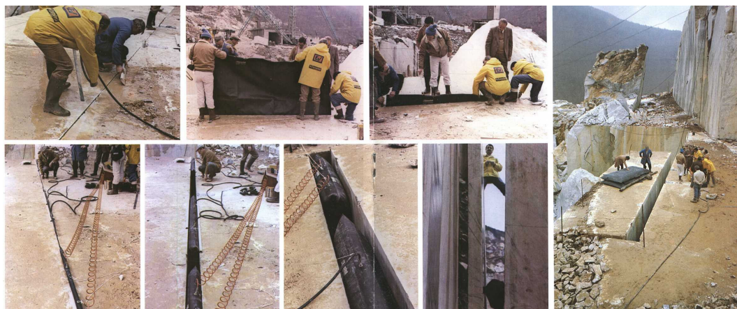
Slika 12.9. - Rad pri obaranju bloka zračnim jastucima tvrtke Eurovinil
