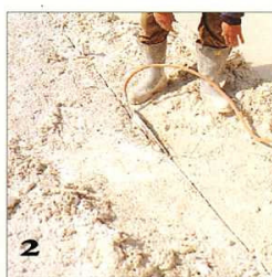
Slika 12.13. - Potiskivanje bloka vodenim jastucima - garnitura Hydrobag
