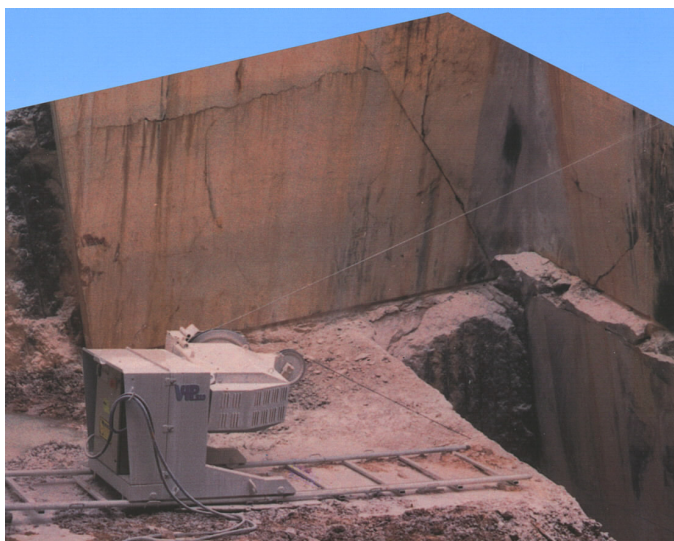
Slika 13.36. - Dijamantna žična pila model VIP 910 pri piljenju u masivu
