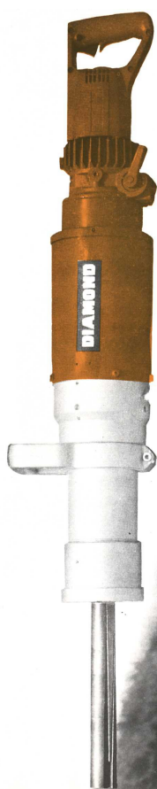
Slika 13. 20. - Posebna izvedba hidrauličnog klina s pogonom na čekiću
