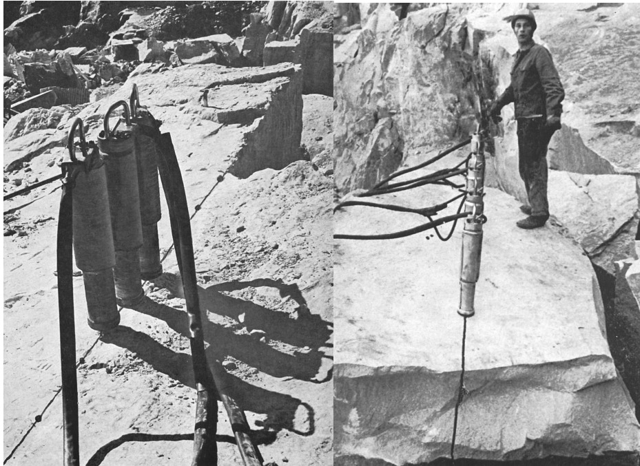
Slika 13.15. - Pucanje bloka pod djelovanjem garniture hidrauličnih klinova
