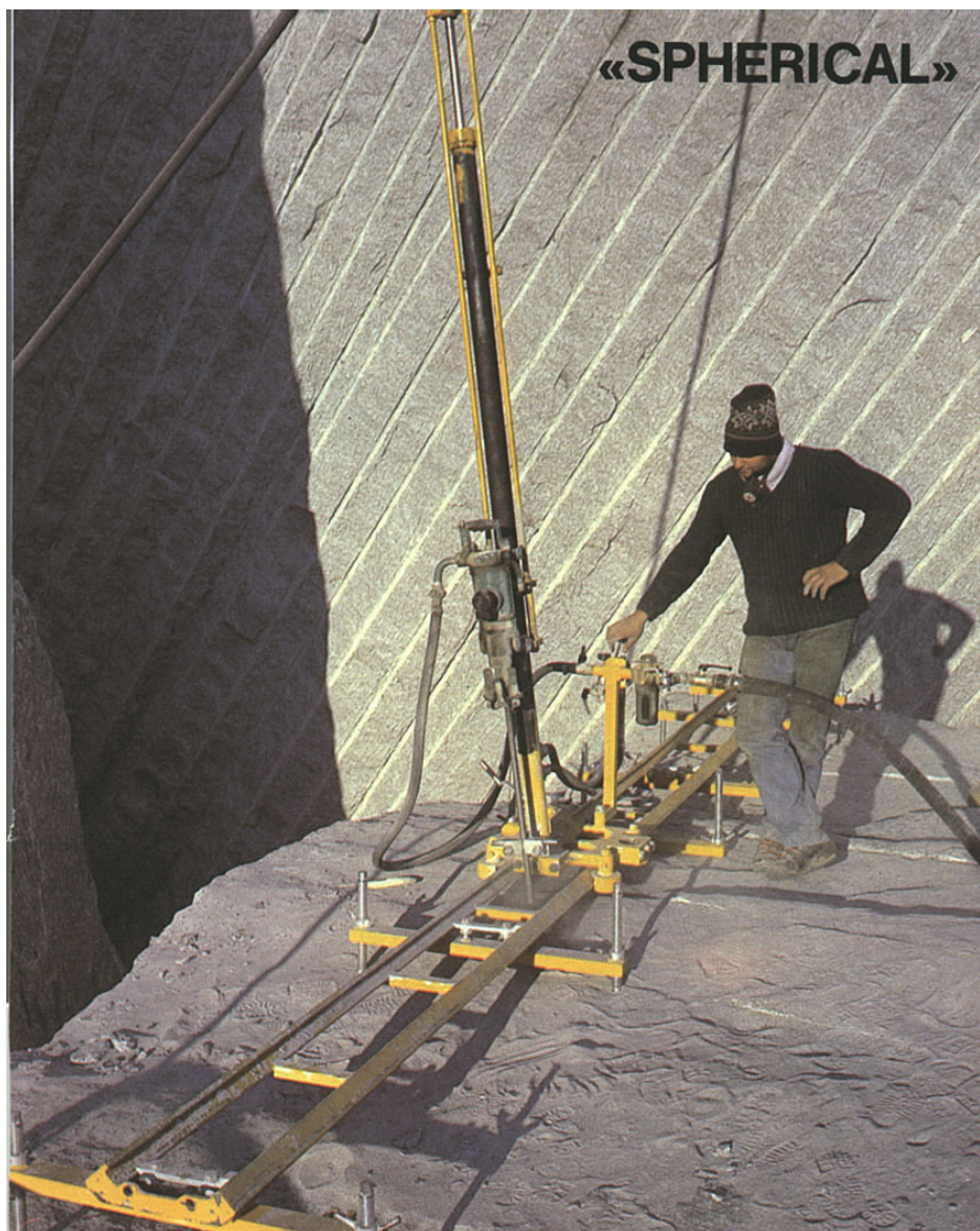
Slika 13.7. - Lafetna bušilica s jednim hidraulično potiskivanim bušačim čekićem; gibanje tornja po udvojenim vodilicama pomoću nazubljene letve
