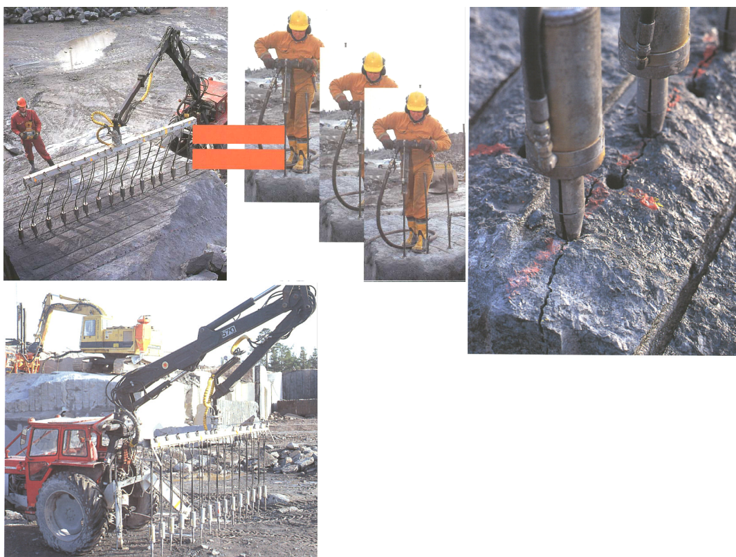
Slika 13.23. - Eksploatacija blokova bušenjem i cijepanjem klinovima pomoću priključne garniture u ležištu kamena silikatnog sastava
