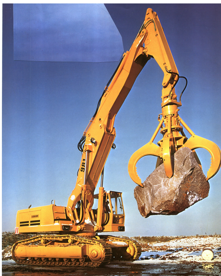
Slika 14.15. - Hidraulični bager s grajferskim radnim elementom - polipni hvatač za kamene blokove
