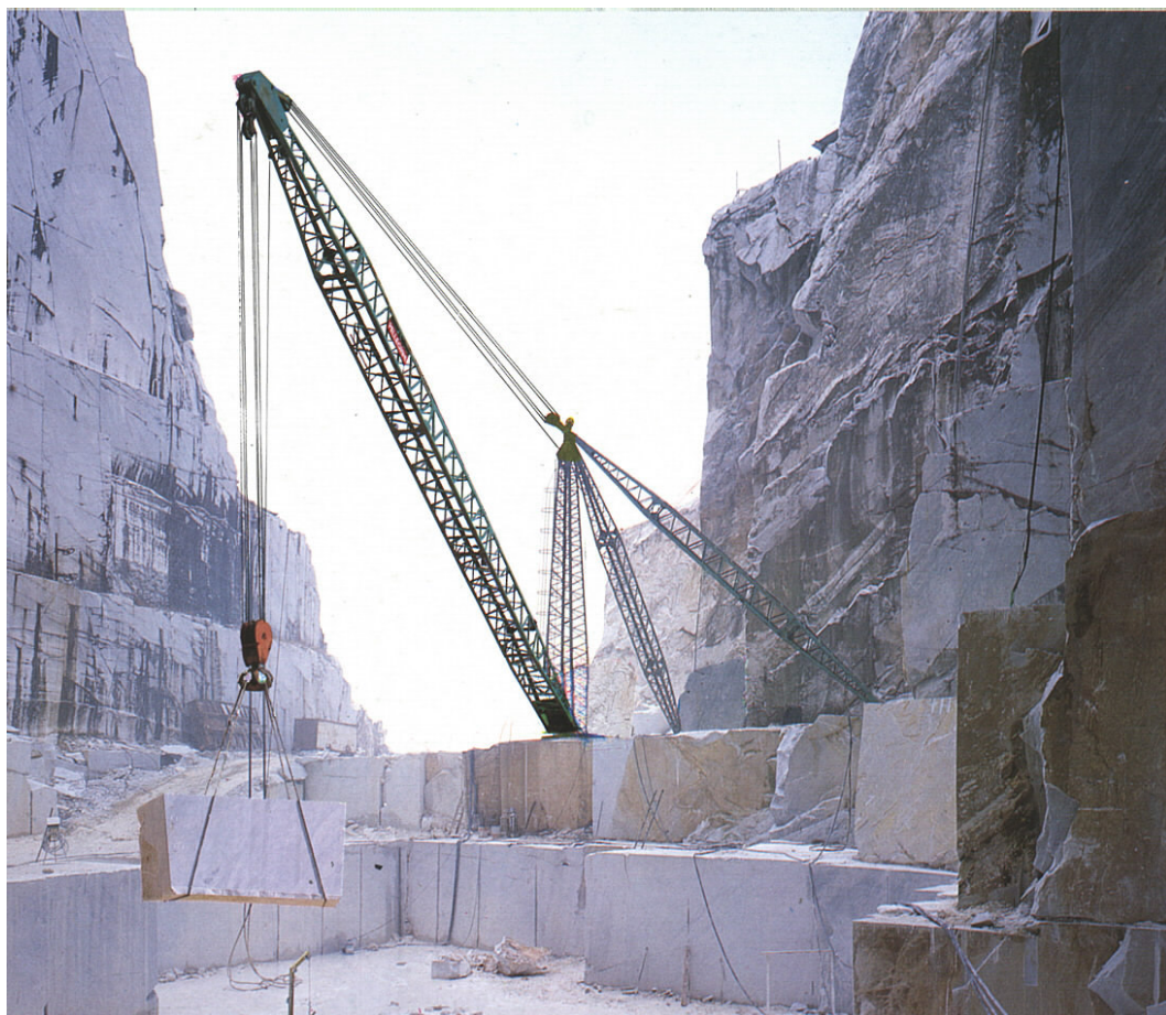
Slika 14.7. - Derik dizalica pri izvlačenju blokova iz dubinskog dijela površinskog brdskog kamenoloma
