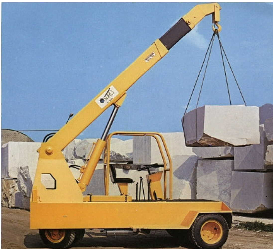
Slika 14.9. - Auto-dizalica od 45 t nosivosti
