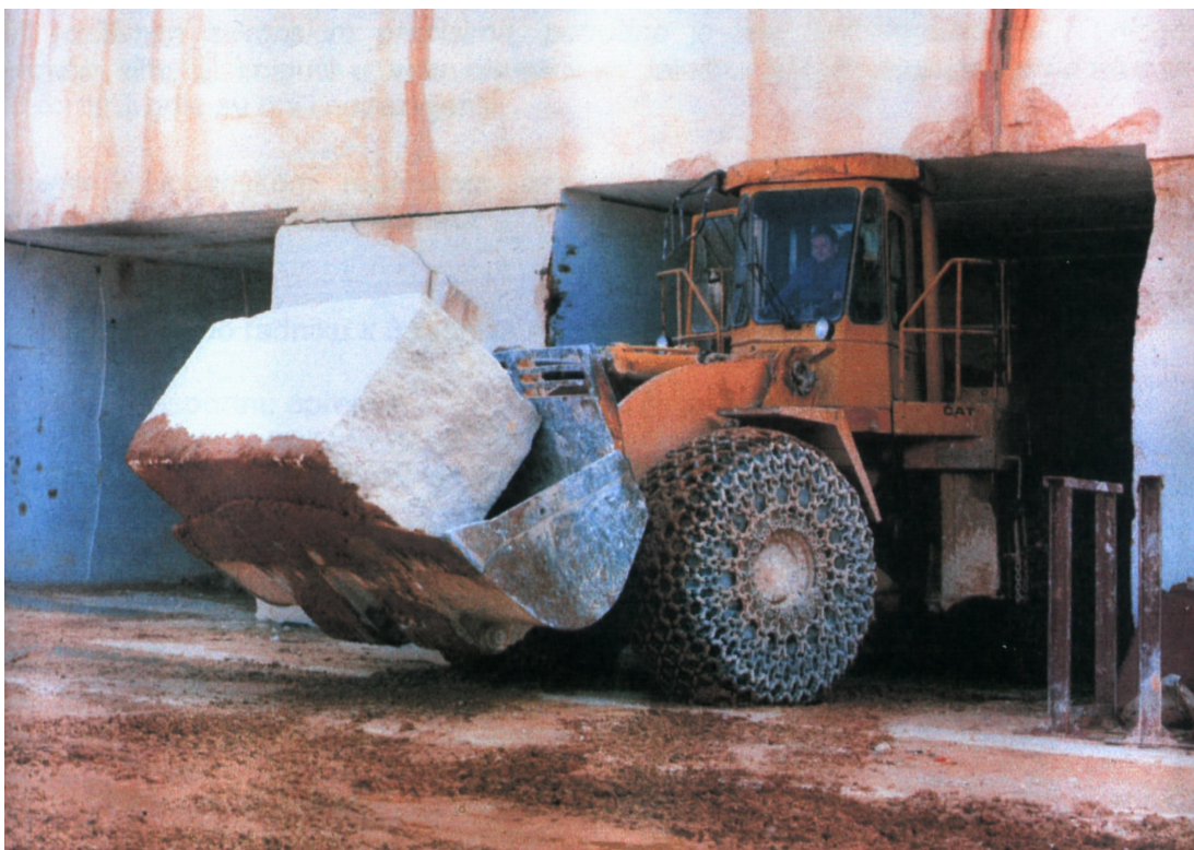
Slika 14.12. - Utovarač Caterpillar model CAT 980 iznosi blok iz podzemnog kamenoloma Kanfanar II s klasičnom utovarnom lopatom
