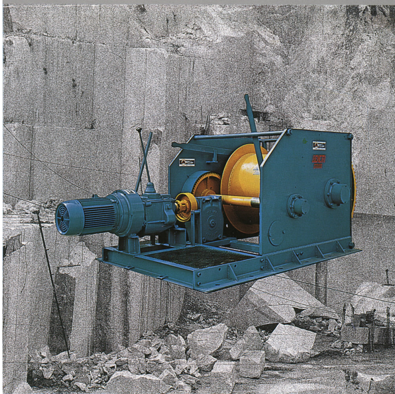
Slika 14.4. - Elektromotorno vučno vitlo za povlačenje teških tereta namijenjeno za rad u kamenolomu
