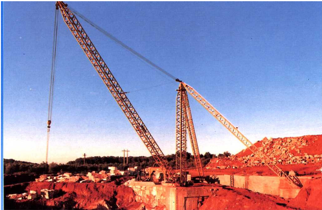
Slika 14.6. - Derik dizalica pri radu u površinskom nizinskom dubinskom kamenolomu
