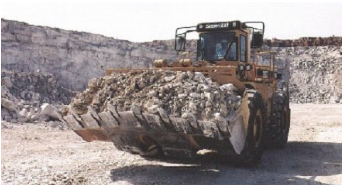
Slide 14.10. - Utovarač na gumenim kotačima s klasičnom utovarnom lopatom pri rukovanju s jalovinom (rasutim teretom)
