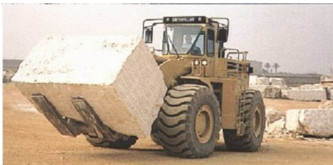
Slide 14.11. - Utovarač na gumenim kotačima s viljuškama umjesto klasične utovarne lopate pri rukovanju s kamenim blokom (komadnim teretom)
