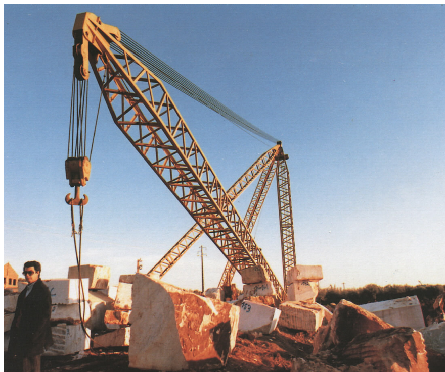
Slika 14.5. - Derik dizalica na površinskom nizinskom plitkom kamenolomu
