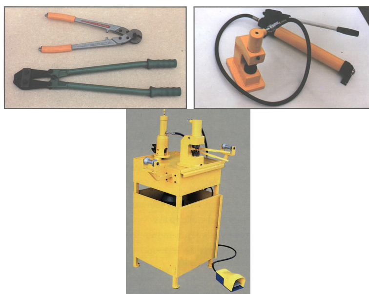
Slika 15.13. - Pribor za formiranje dijamantne žice: kliješta (gore lijevo); ručna hidraulična presa (gore desno); montažni stol (dolje)
