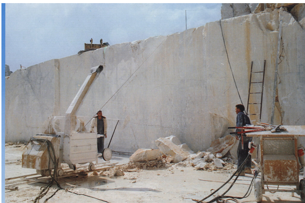
Slika 15.3. - Dijamantna žična pila s automatskom regulacijom napinjanja žice ovisno o naprezanjima u rezu
