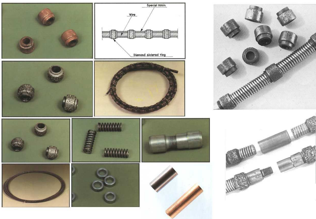
Slika 15.11. - Elementi od kojih se formira dijamantna žica njihovim nanizavanjem na čelično užje: dijamantne perle (galvanske i sintetizirane); razdjelne opruge; zaštitni prstenovi; blokirni osigurači; spojnice (cjevaste i spojnice s muško-ženskim navojem)
