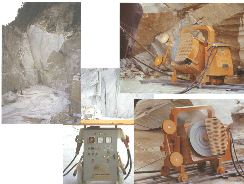
Slika 15.9. - Piljenje kosog reza dijamantnom žičnom pilom
