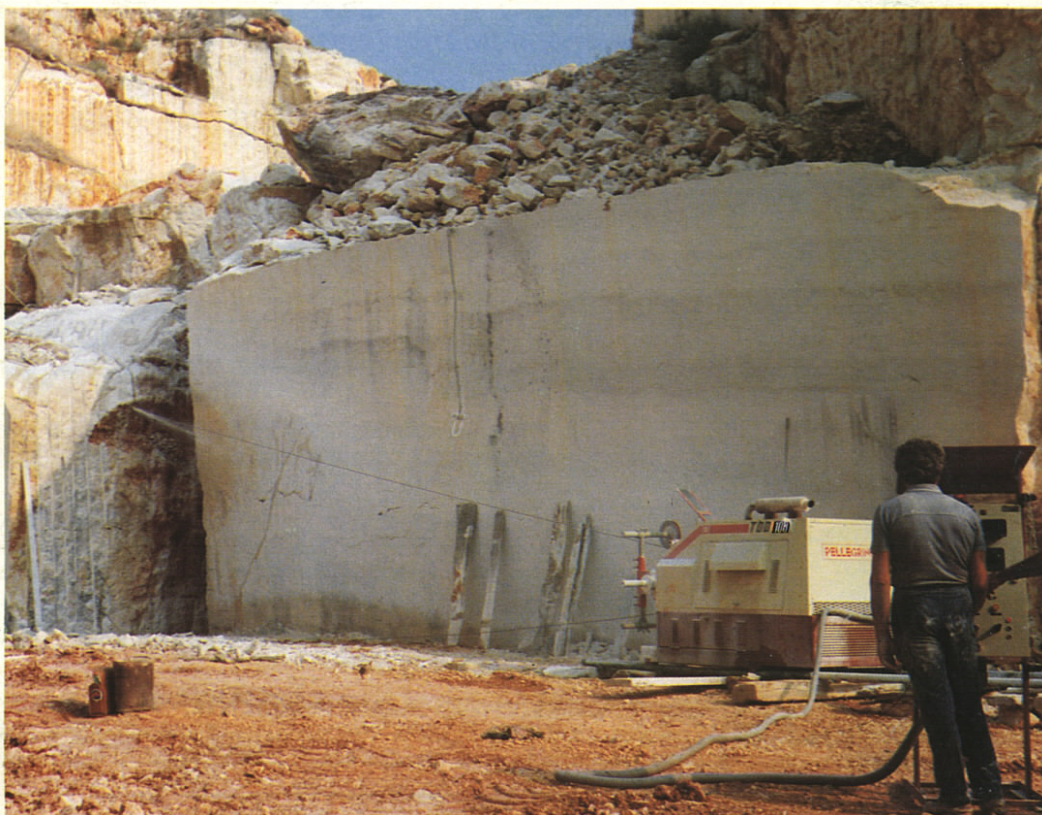
Slika 15.4. - Dijamantna žična pila, kojoj je u hidrostatičkom sustavu glavni pogonski motor dizelski motor
