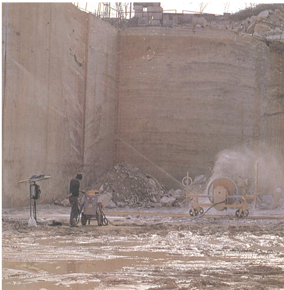
Slika 15.2. - Dijamantna žična pila u kamenolomu travertina
