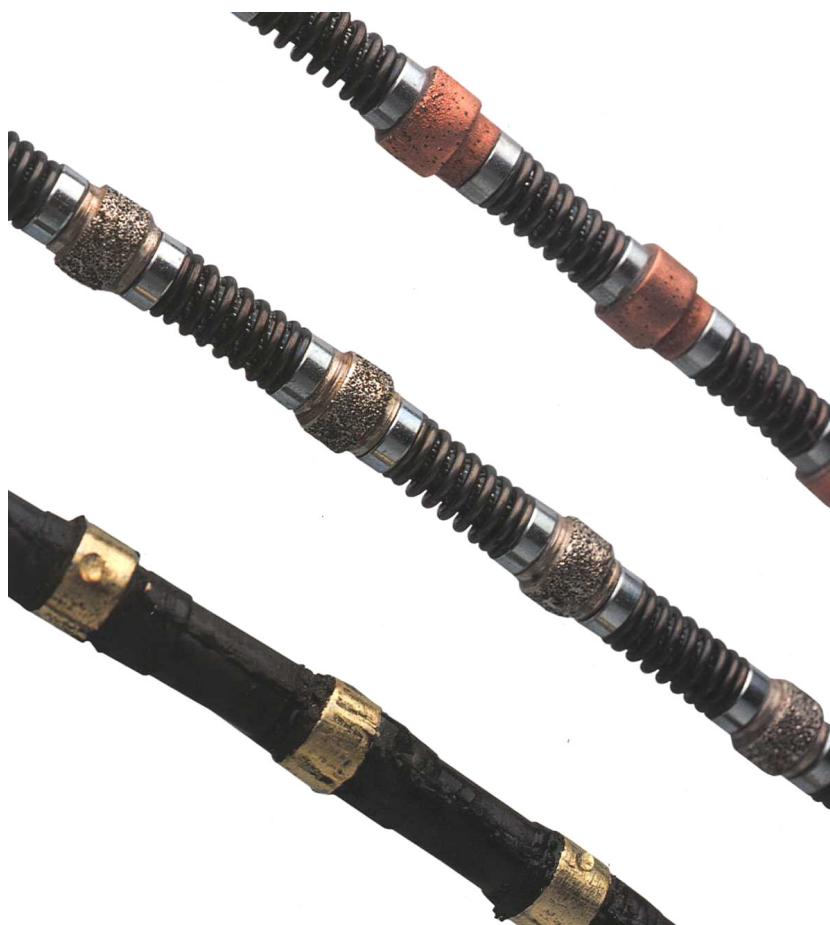
Slika 15.10. - Vrste dijamantne žice: za piljenje karbonatnih stijena - galvanske perle (gore); za piljenje karbonatnih stijena - sintetizirane perle (u sredini); za piljenje silikatnog kamena (dolje) - žica obložena plastikom zbog zaštite čeličnog užeta od prebrzog habanja
