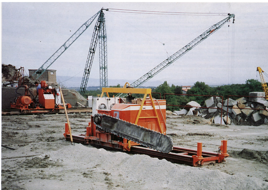
Slika 16.5. - Laganija izvedba lančane sjekačice Fantini pri radu na početnom otvaranju usjeka, tj. pri početku rada na otvaranju dubinskog kamenoloma
