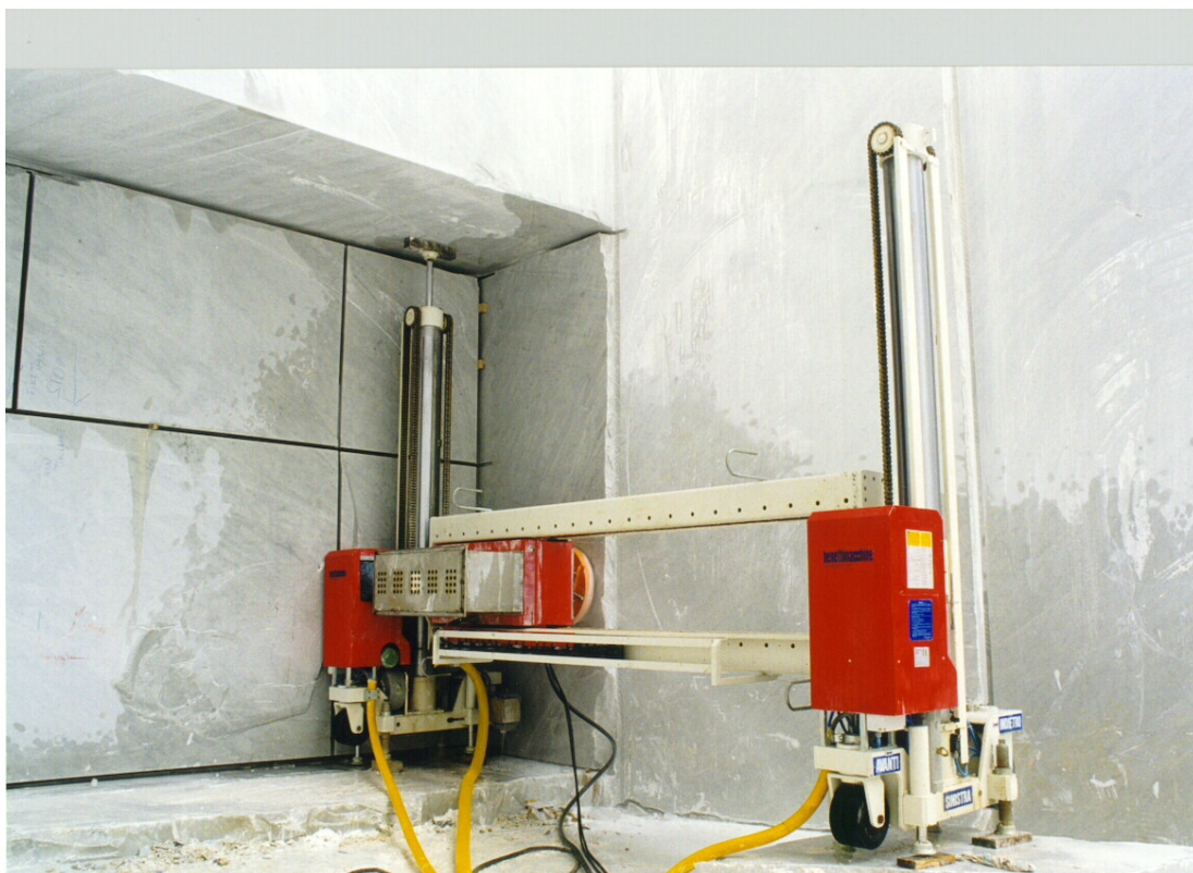
Slika 16.22. - Dijamantna remenska pila model Tunnel jet belt 940 proizvod Benetti macchine pri podzemnom otkopavanju
