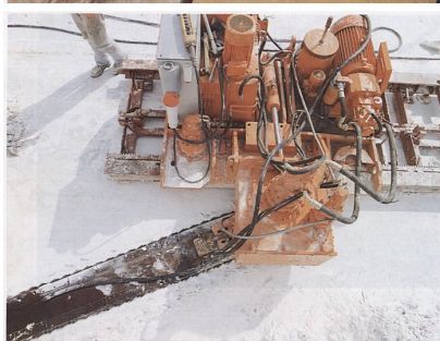
Slika 16.6. - Različite izvedbe lančanih sjekačica u različitim fazama piljenja vertikalnih i horizontalnih rezova
