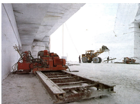
Slika 16.5. - Laganija izvedba lančane sjekačice Fantini pri radu na početnom otvaranju usjeka, tj. pri početku rada na otvaranju dubinskog kamenoloma
