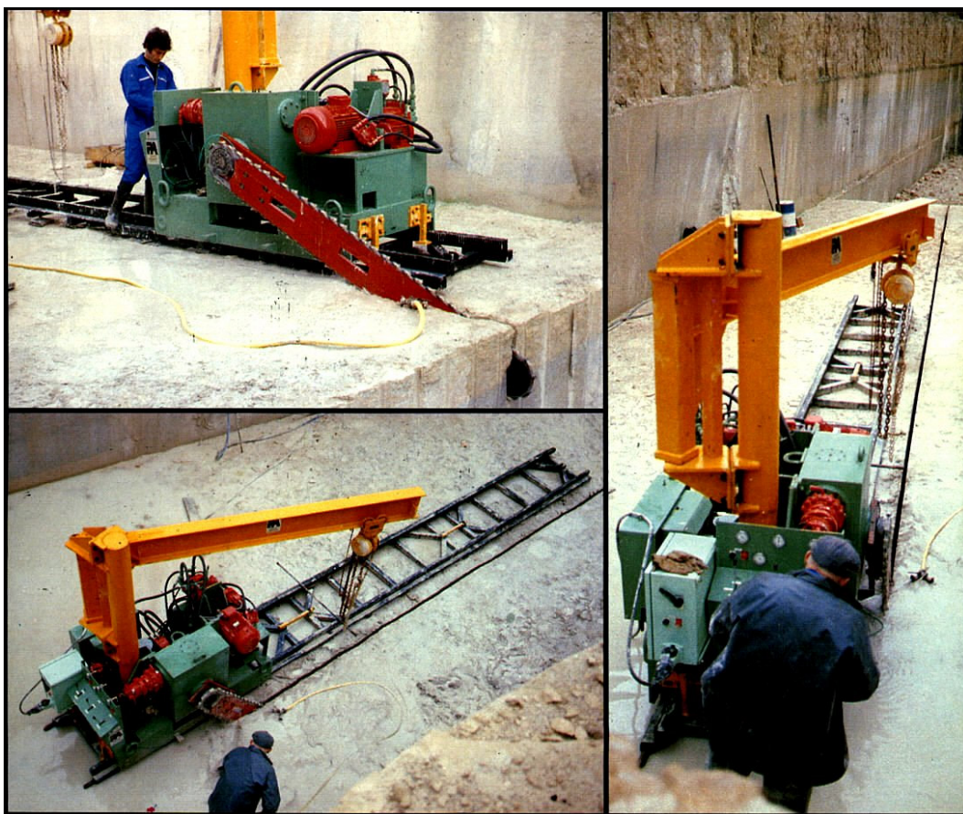
Slika 16.3. - Lančana sjekačica francuske tvrtke Perrier pri piljenju horizontalnog reza u kamenolomu
