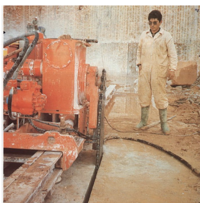
Slika 16.5. - Laganija izvedba lančane sjekačice Fantini pri radu na početnom otvaranju usjeka, tj. pri početku rada na otvaranju dubinskog kamenoloma
