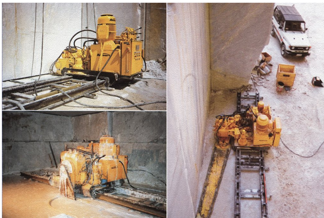
Slika 16.4. - Novija izvedba sjekačice Korfman postavljena za piljenje horizontalnog reza (desno), pri piljenju horizontalnog reza (lijevo gore) i pri piljenju vertikalnog reza (lijevo dolje)
