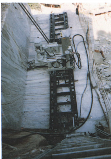
Slika 16.18. - Dijamantna remenska pila u različitim fazama piljenja horizontalnog reza
