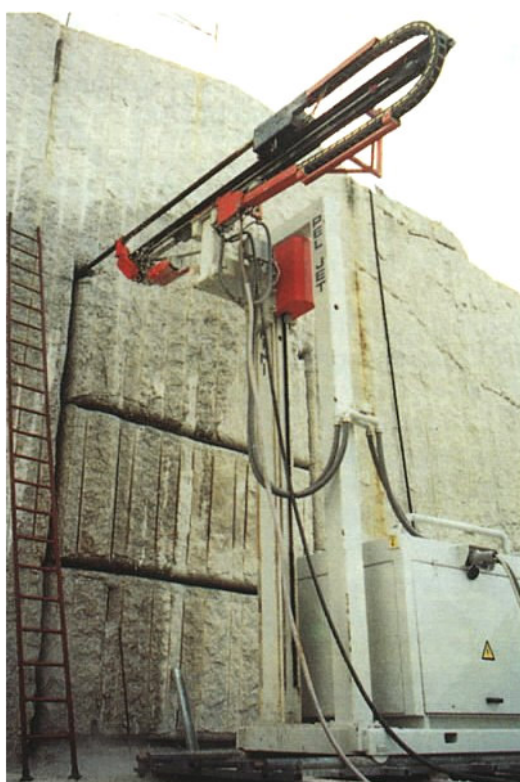
Slika 16.26. - Postrojenje Pel-jet tvrtke Pellegrini Meccanica S.p.a. pri piljenju horizontalnog (gore) i vertikalnog reza (dolje)
