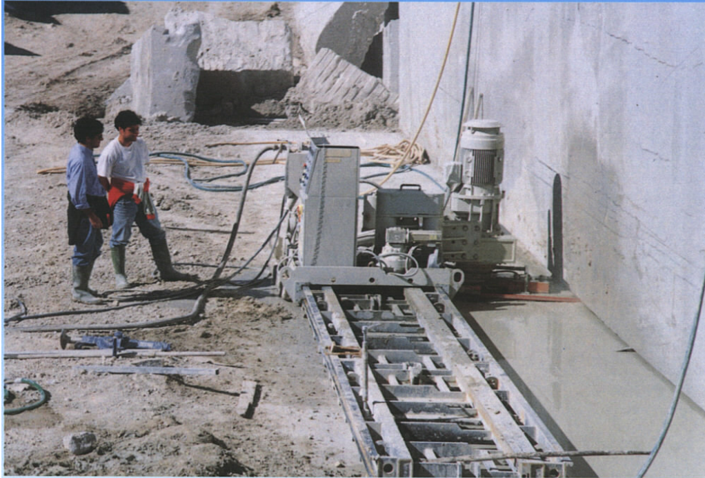
Slika 16.17. - Dijamantna remenska pila model Super Jet Belt 950 pri piljenju horizontalnog reza
