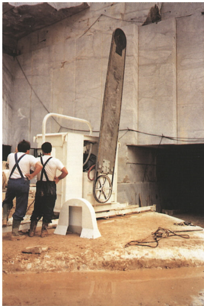
Slika 16.20. - Dijamantna remenska pila povećane dužine ruke u podzemnom kamenolomu
