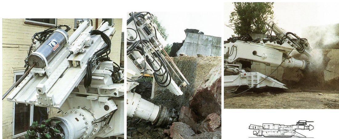
Slika 63 Stroj za sukcesivni iskop stijena u podzemlju s „vodenim topom“ (Promidžbeni materijali tvrtke Dosco)
