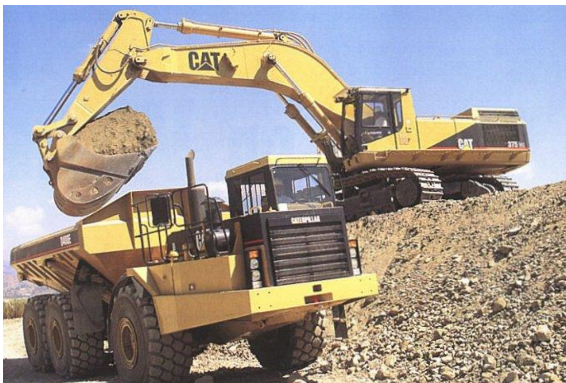
Slika 66 Bager s dubinskom lopatom (Promidžbeni materijali tvrtke Caterpillar)
