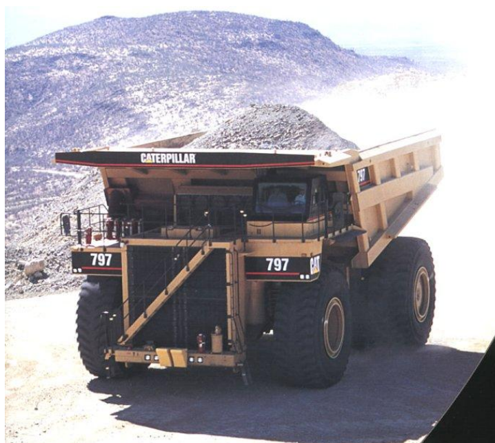
Slika 8 Dizel-električni kamion marke Caterpillar model 797 nosivosti 360 t, snage 2537 kW , 1750 okretaja u minuti (Promidžbeni materijal tvornice Caterpillar).
