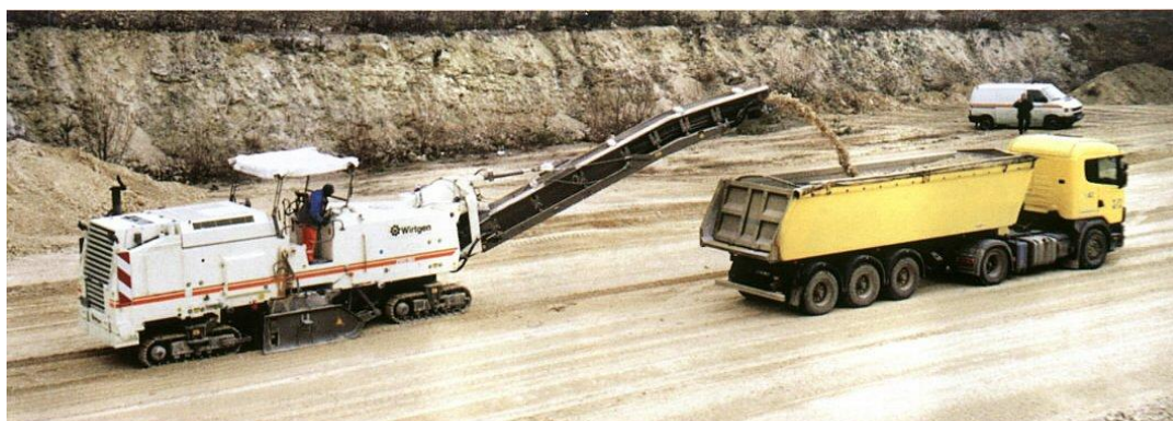
Slika 58 Stroj za kontinuirani iskop stijena na površini tvrtke “Wirtgen” (Promidžbeni materijali)
