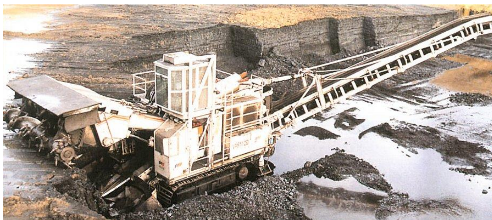
Slika 60 Stroj za kontinuirani iskop stijena na površini tvrtke Voest-Alpine (Promidžbeni materijali)
