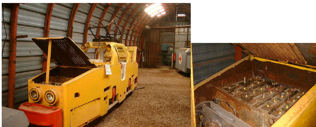
Slika 7 Rudarska lokomotiva s kombiniranim napajanjem električnom energijom iz vozne žice ili iz baterija (Promidžbeni materijal tvornice Clayton)
