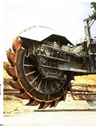
Slika 95 Rotor s ćelijama (a) i bezćelijski rotor (b)
