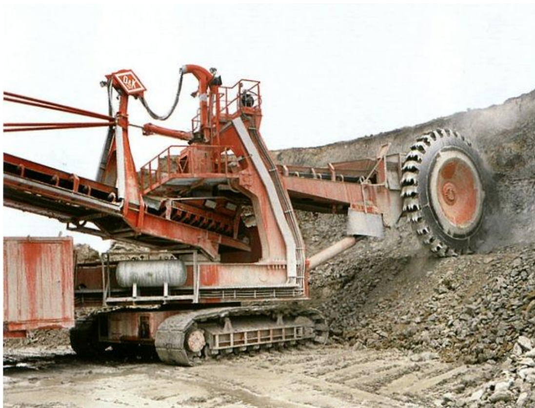
Slika 71 Rotorni bager tvrtke “Krupp” za tvrde stijene (Promidžbeni materijali tvrtke O&K)
