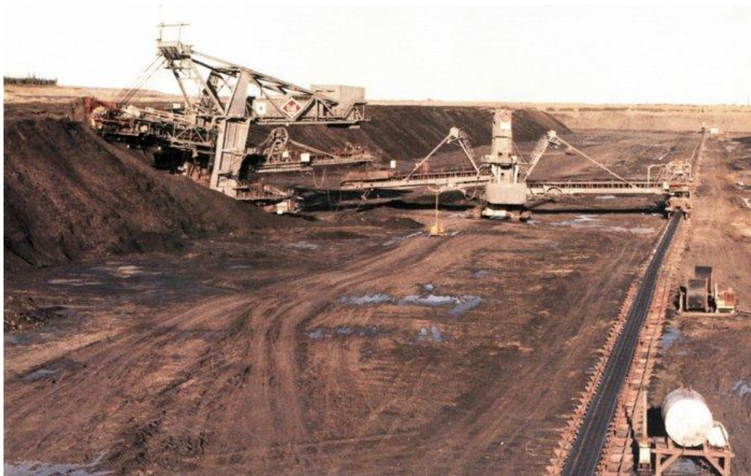
Slika 99 Otpremni most s gumenim transporterom na vlastitom voznom postolju (Promidžbeni materijali tvornice O&K)
