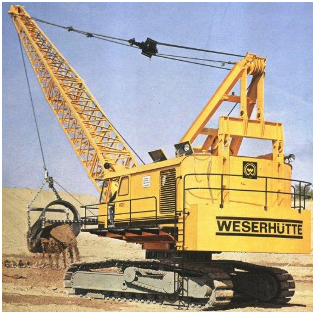
Slika 67 Skreperski bager – “dreglajn” (Promidžbeni materijali tvrtke Weserhutte)
